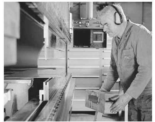
Figura 5: pressa piegatrice con comando a due mani.
