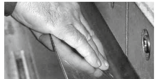
Figura 8: rischi residui non eliminabili: – durante la piegatura sussiste il pericolo che le dita rimangano schiacciate tra la lamiera e la macchina; – durante il sollevamento dell'utensile le dita possono facilmente trovarsi tra l'utensile e il piano di lavoro. In entrambi i casi bisogna prestare particolare attenzione.
