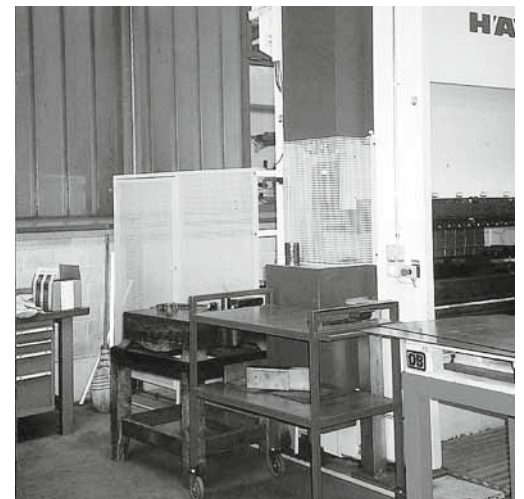
Figura 6: l'accesso laterale e posteriore alla macchina è impedito in modo sicuro.
