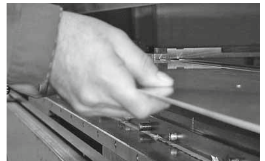
Figura 7: la lamiera deve poter essere spinta lungo il piano di lavoro in modo tale che il pollice sia rivolto verso l'esterno (basso pericolo di schiacciamento).
