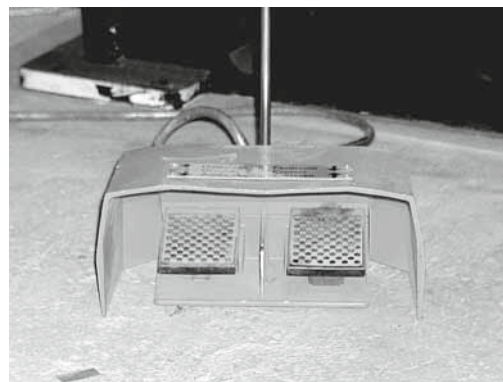
Figura 4: il comando a pedale doppio è coperto e quindi protetto dall'avviamento accidentale dell'operazione di chiusura. Premendo il pedale sinistro il punzone si solleva.
