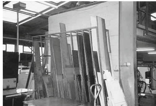
Figura 1: lamiera stoccata in modo ben visibile e sicuro.
