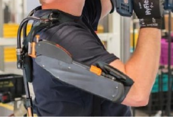
Figura 2 Esoscheletro passivo per supporto degli arti superiori
